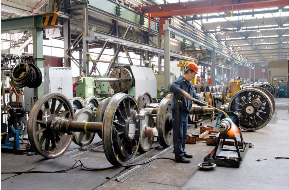
Abbildung 14: Die großen Treibräder der Dampflokomotiven wurden als Speichenräder ausgeführt, um Gewicht zu sparen. Die Abbildung zeigt die Radsatzaufarbeitung im DB Werk Cottbus.
