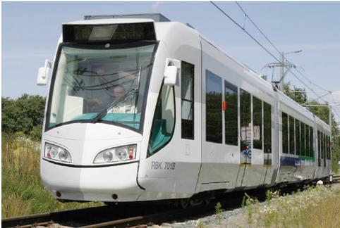
Abbildung 4: Zweisystemfahrzeug für den Mischbetrieb auf EBO- und BOStrab-Strecken
